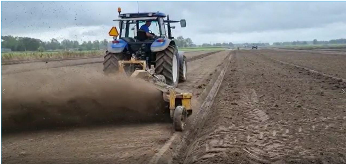
Afbeelding: Perceel waar in september van dit jaar kruidenrijk grasland wordt ingezaaid in combinatie met greppel plas-dras. Op de foto een trekker met wallenfrees in actie voor het aanleggen van een greppel plas-dras .
